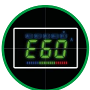
Protección de sobre temperatura
